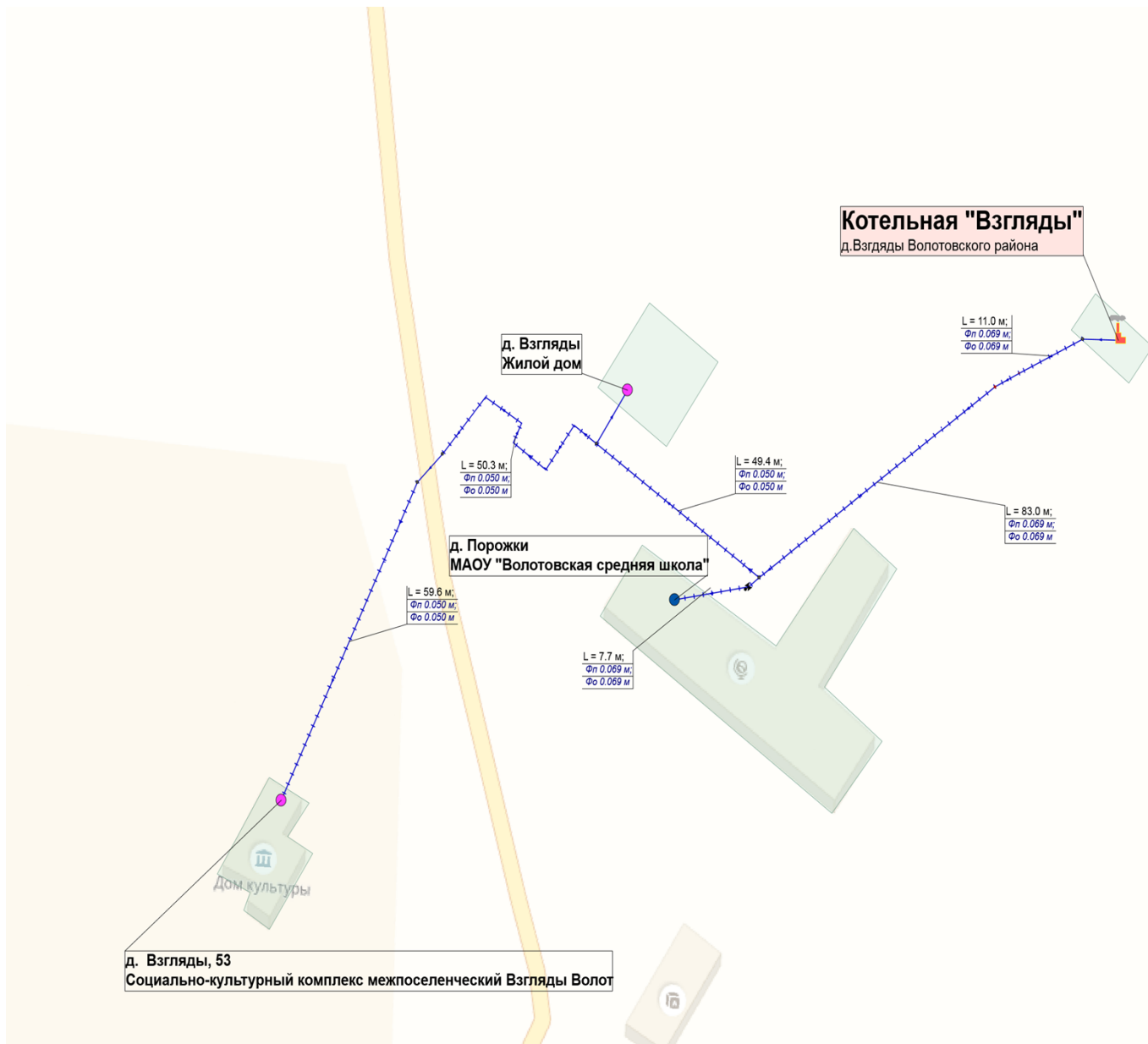
Рисунок 1.2. - Схемы тепловых сетей котельной № 9 д. Взгляды
